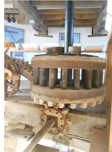
Schijfloop die de haverbreker aandrijft
